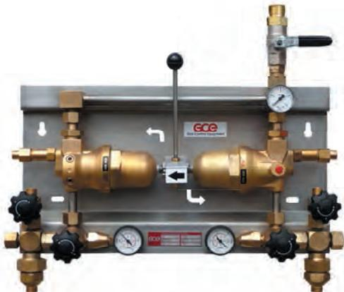
El panel de regulación y cambio semiautomático MS400 regula la presión de los gases comprimidos a 300 bar/ 4000 psi a un nivel de suministro de 18 - 20 bar o 36 - 40 bar. Se ha diseñado para su uso con 2 fuentes de gas (cilindros o baterías de cilindros).
