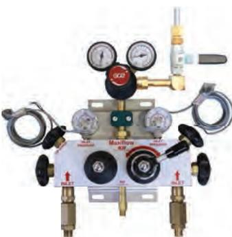
El MAXIFLOW 2/2 es una unidad de regulación y cambio de doble etapa que brinda una presión de servicio estable. Las versiones equipadas con manómetros de contacto permiten dar una alarma cuando el cilindro esta por agotarse. Da tiempo de solicitar cilindros llenos y el panel MAXIFLOW cambia automáticamente al lado de reserva.
